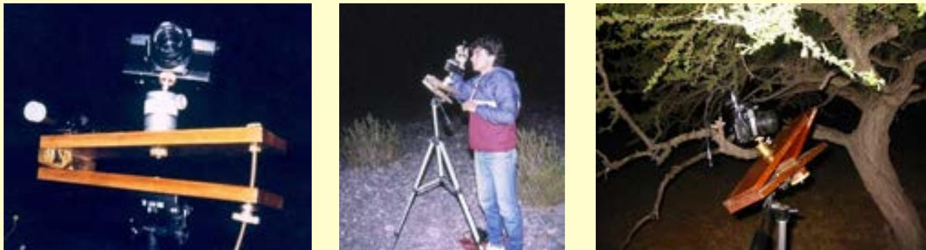
Figura 6. Construcción y uso de plataformas ecuatoriales para fotografiar el cielo nocturno con seguimiento. En este período se construyeron las plataformas ecuatoriales de brazo simple (1987, a la izquierda) y de brazo doble (1989, a la derecha). En la fotografía central un estudiante de la época está utilizando una plataforma ecuatorial en una salida a terreno.
