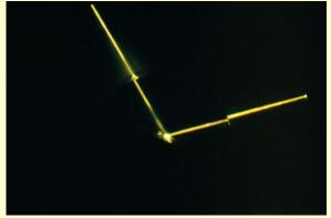
Un rayo de luz incide en un semicilindro de plástico, se refracta y hay reflexión total.
