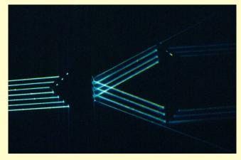
Rayos de luz inciden en un prisma de plástico, se refractan, llegando a otros dos prismas, como se observa en la fotografía.
