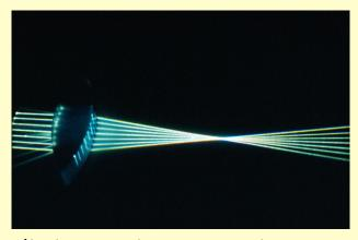
Múltiples rayos luminosos inciden en una lente cilíndrica biconvexa. Los rayos se refractan en la lente y convergen en el foco.
