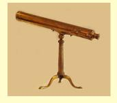
Telescopio refractor de Kepler (réplica), consistente en dos lentes convergentes. La lente objetivo de mayor distancia focal que la del ocular.
