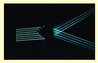
Rayos luminosos inciden por las caras del vértice de un prisma de plástico, se refractan y divergen.
