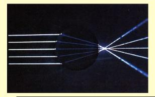
Rayos de luz inciden en un cilindro de plástico, se refractan convergiendo. Notar los rayos refractados en el interior del cilindro. Se utiliza como un modelo de arco iris haciendo incidir un único rayo luminoso.
