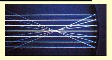
Rayos de luz inciden en un espejo cilíndrico, se reflejan convergiendo en un punto, el foco del espejo.
