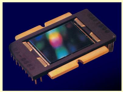
CCD con 1,3 millones de pixeles. La superficie fotosensible de este CCD de 20,5 x 16,4 mm. Cada pixel es un cuadrado de 16 micrones por lado.
