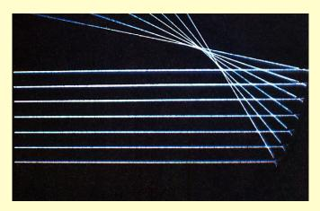
Cuando rayos de luz inciden en un espejo curvo un poco desviado del eje óptico, se reflejan mostrando que no convergen en un punto. ¿Cuál es la explicación de este efecto?
