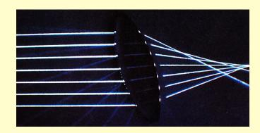
Rayos de luz inciden en una lente cilíndrica de plástico, desviada un poco del eje óptico, se refractan. ¿Cómo se explica el efecto mostrado?
