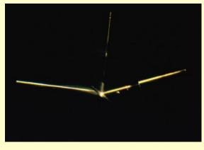
Un rayo de luz incide en un semicilindro de plástico, se refracta en un ángulo cercano al de reflexión total.
