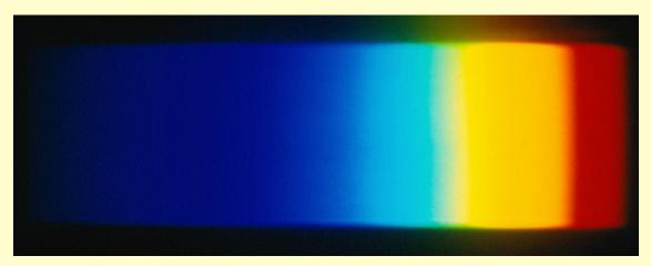
Un rayo de luz blanca incidiendo en un prisma, se refracta dispersando la luz en un espectro continuo.
