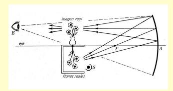
Esquema del montaje para obtener una ilusión óptica producida por una imagen real de aumento unidad.
