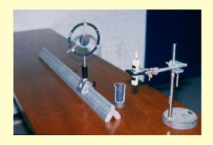
Montaje para mostrar la llama de una vela invertida. El elemento óptico es un espejo esférico. ¿A qué distancia está el objeto del espejo?
