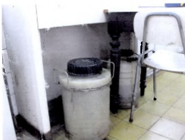
Envases plásticos con formalina sin sellos de seguridad, ubicados en un lugar inapropiado
