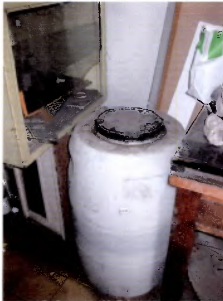
Envase plástico con formalina sin sellos de seguridad, ubicado en un lugar inapropiado
