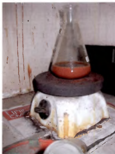
Agitador magnético dañado, empleado sólo para procesos de evaporación
