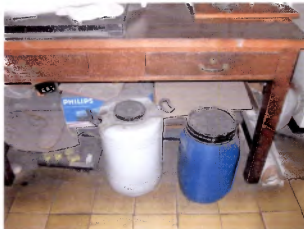
Envases plásticos con formalina sin sellos de seguridad, ubicados en un lugar inapropiado Falta de aseo
